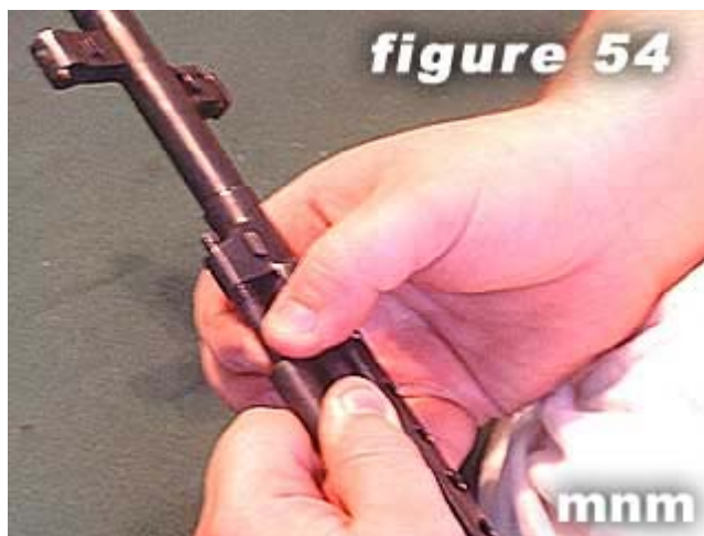
54) Attach gas piston.
