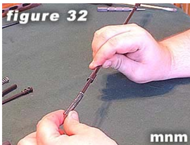
32) Remove piston spring .
