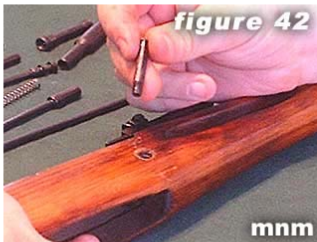
42) Remove cross pin screw .
