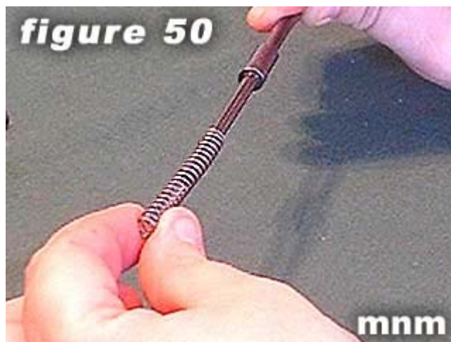
50) Replace piston spring.
