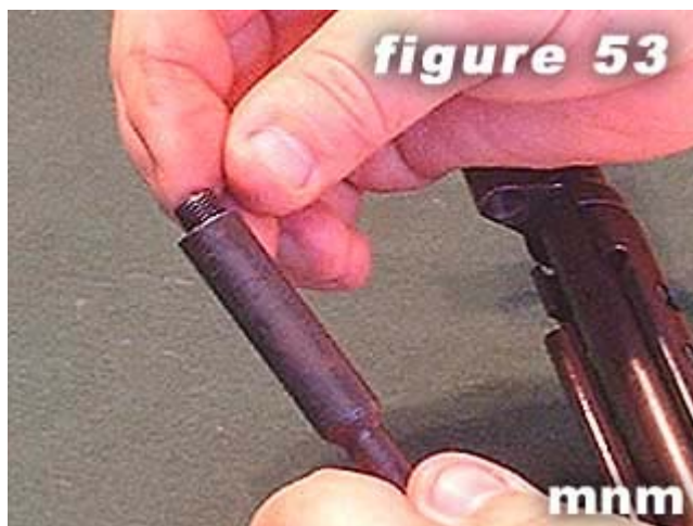
53) Reinstall the gas piston.
