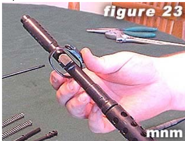
23) Remove the swivel band .
