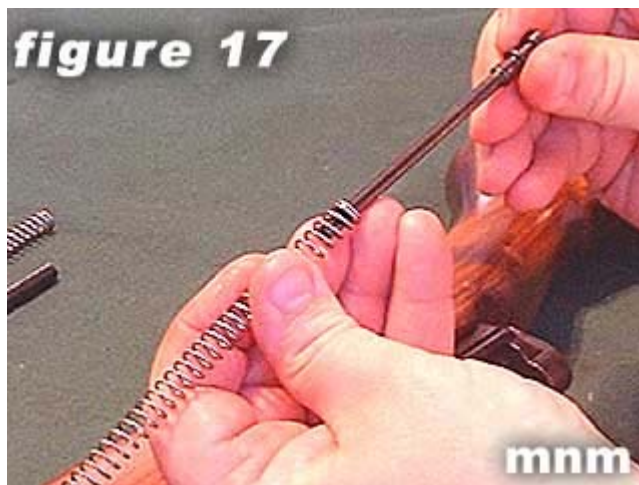
17) Remove rear spring guide .
