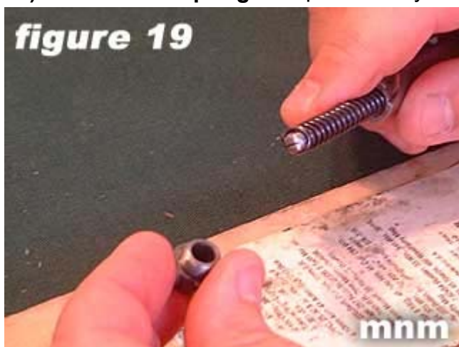
19) Remove striker spring retainer .
