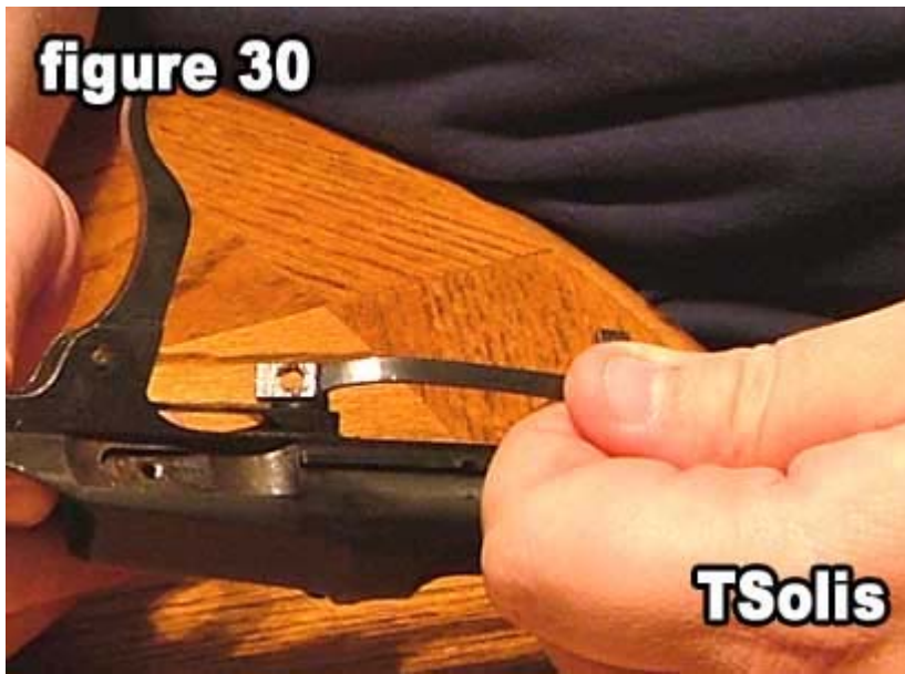
30) Remove the ejector spring.
