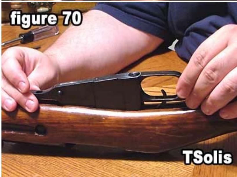
70) Replace the trigger guard.
