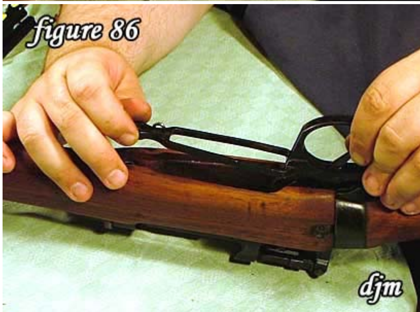
86) Replace the trigger guard.
