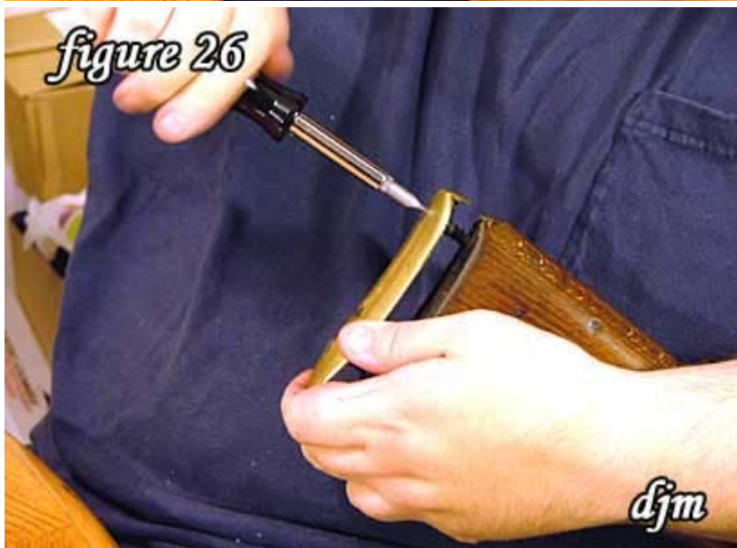
26) Remove the butt plate.
