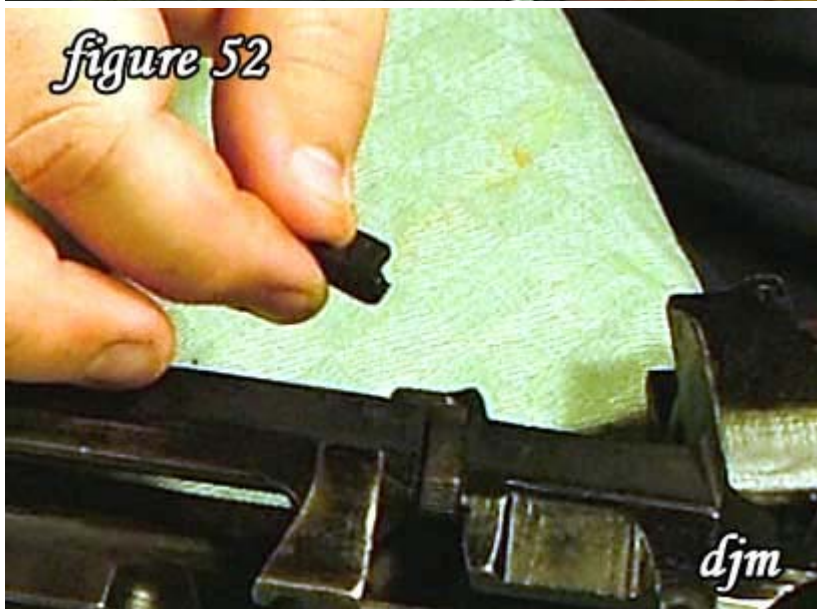
52) Remove the bolt head catch plate.
