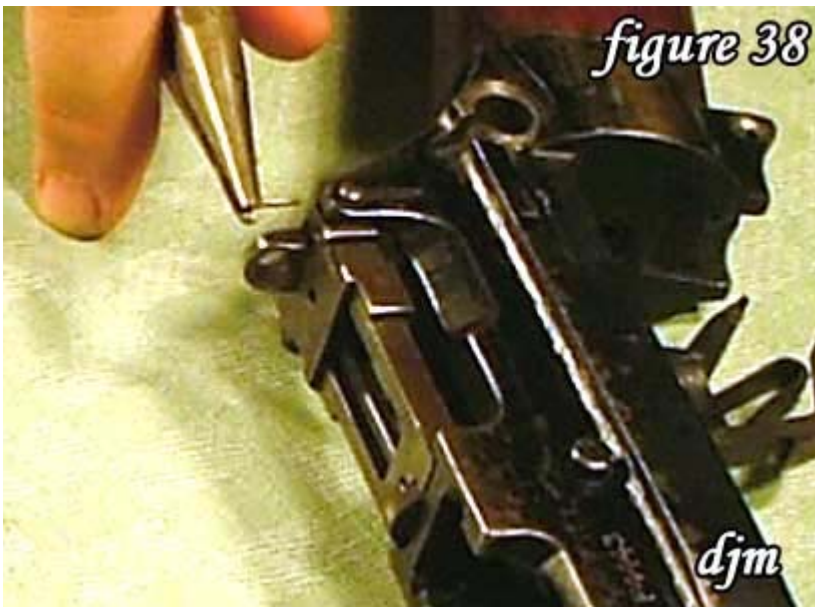
38) Remove the retaining pin.
