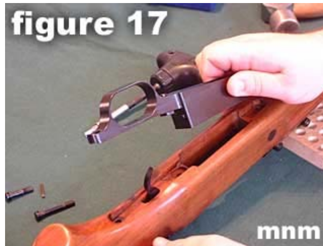
17) Remove the trigger guard .
